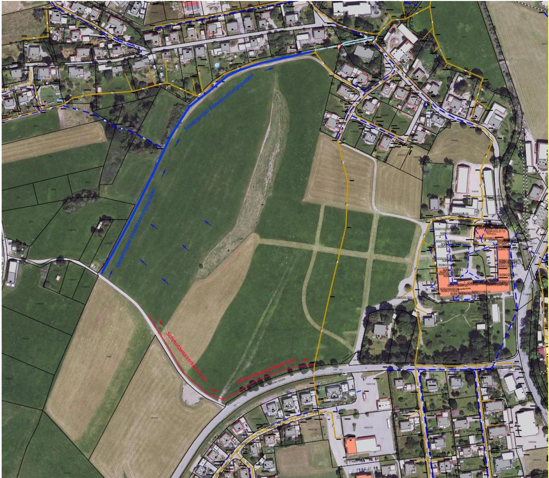
Abbildung 5 – Geplantes Entwässerungskonzept (blau: Ableitung Niederschlagswasser, rot: Ableitung Schmutzwasser), ohne Maßstab
